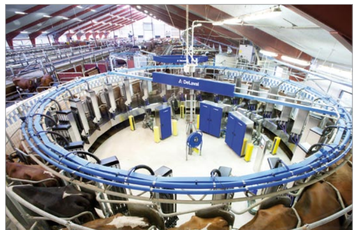
Automatisches Melkkarussell (AMR) von De Laval, wie es in die Dielsdorfer Milchviehanlage eingebaut wird.
