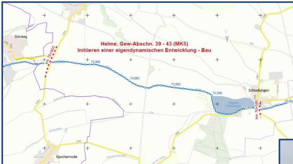
Die Helme wurde in der Vergangenheit stark begradigt und mit einem tiefen und regelmäßigen Profil ausgebaut. Zusätzlich erfolgte eine Befestigung der Böschungsfußbereiche mit Steinschüttungen. Zielstellung des Gewässerausbaus war es, Hochwasser aus den Auen schneller abzuführen und eine intensivere landwirtschaftliche Nutzung zu ermöglichen.
